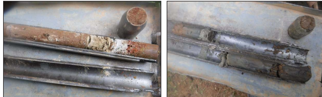
Muestras de los materiales de relleno (capa R) en el sondeo S-2, a 9,0 y a 13,0 metros, respectivamente.
