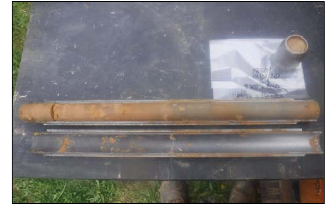
Foto 20: S-3; SPT a 8,8 metros
