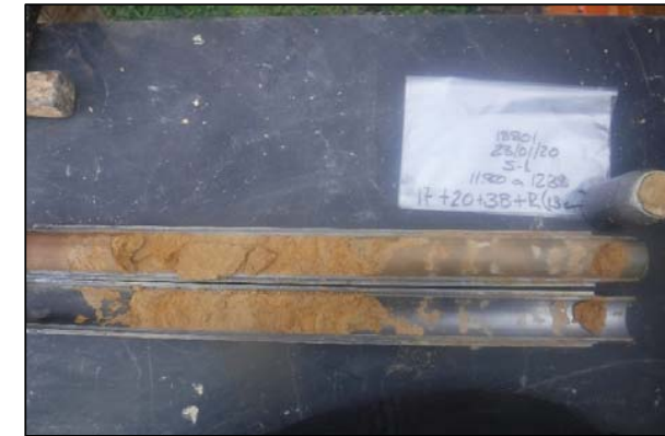
Foto 21: S-3; SPT a 11,8 metros
