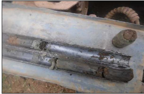
Foto 13: S-2; SPT a 13,3 metros
