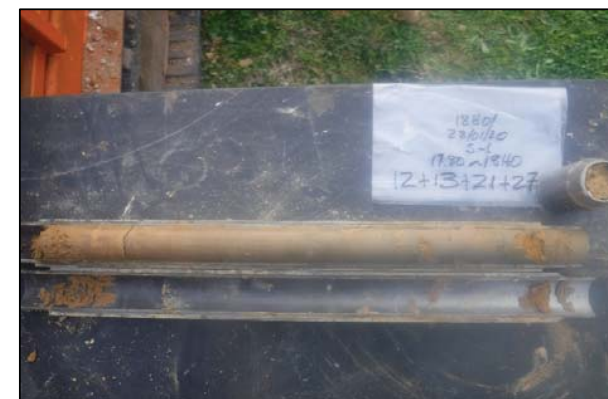
Foto 23: S-3; SPT a 17,8 metros
