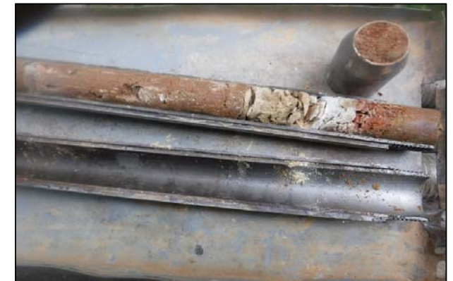
Foto 12: S-2; SPT a 9,0 metros
