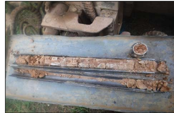
Foto 9: S-2; SPT a 1,0 metros
