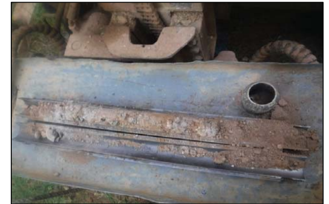
Foto 10: S-2; SPT a 3,6 metros
