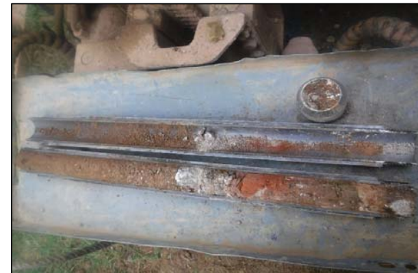
Foto 11: S-2; SPT a 6,6 metros
