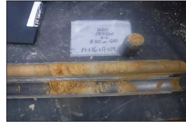
Foto 19: S-3; SPT a 5,8 metros
