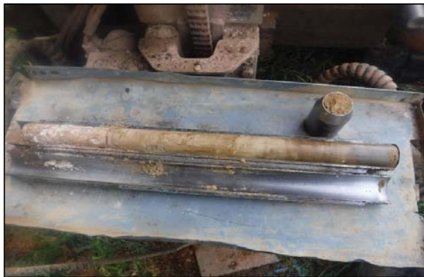
Foto 5: S-1; SPT a 6,6 metros
