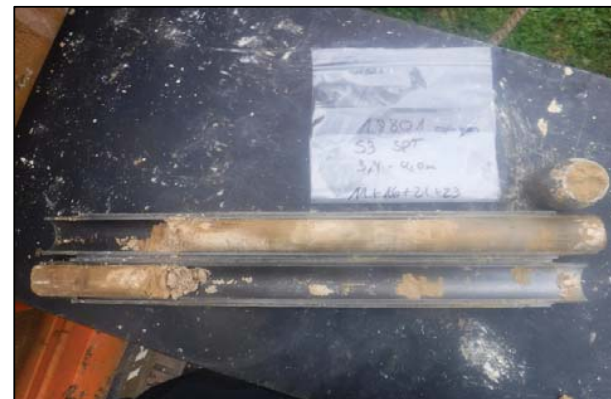
Foto 18: S-3; SPT a 3,4 metros
