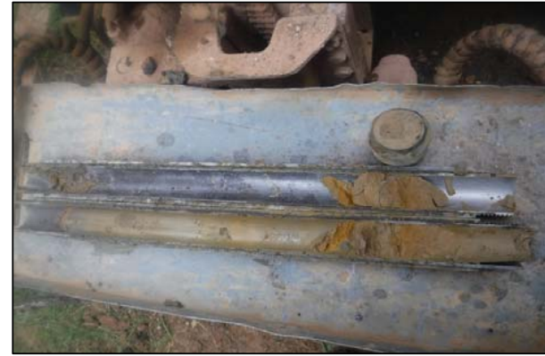
Foto 14: S-2; SPT a 18,4 metros
